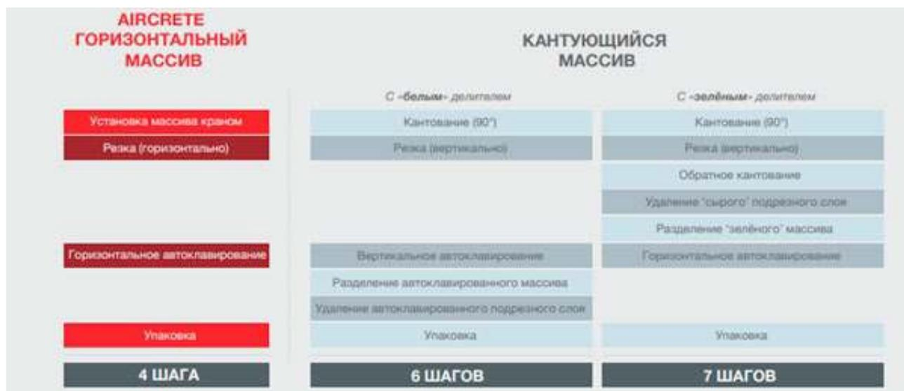
**Рис. 2. Небольшое количество манипуляций при использовании технологии резки массива в горизонтальном положении значительно снижает риск повреждения мягкого и уязвимого массива до автоклавирования**
