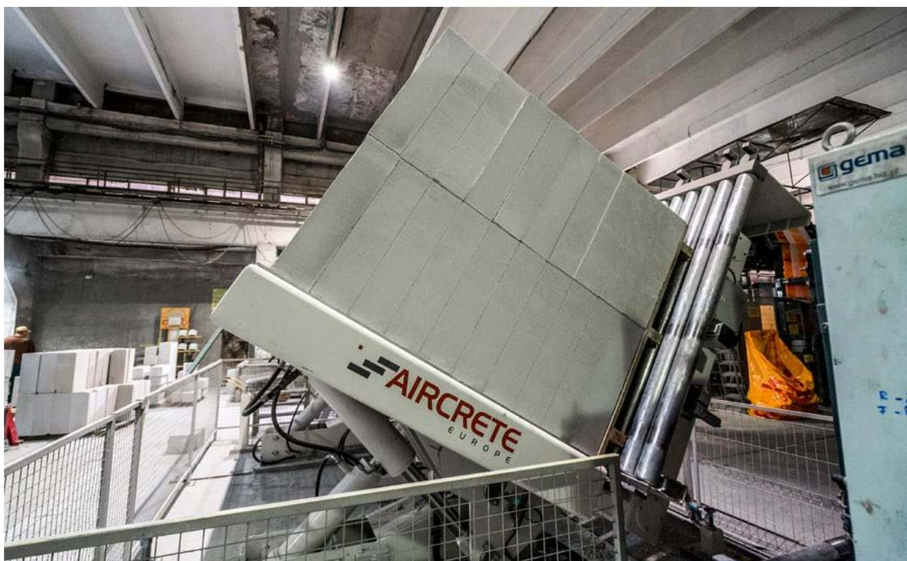
**Рис. 5. Блоки наклонены на 90° для их укладки на поддоны большей поверхностью**
