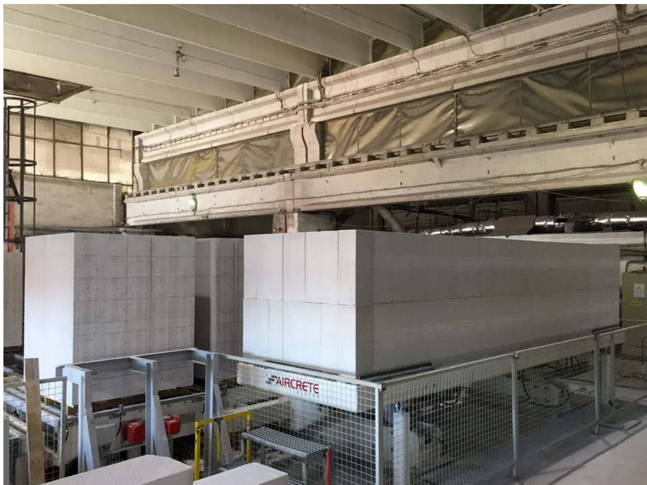
Рис. 4. Новый поворотный стол и транспортер для поперечного перемещения поддонов с продукцией внедрены в зоне упаковки для Celco
